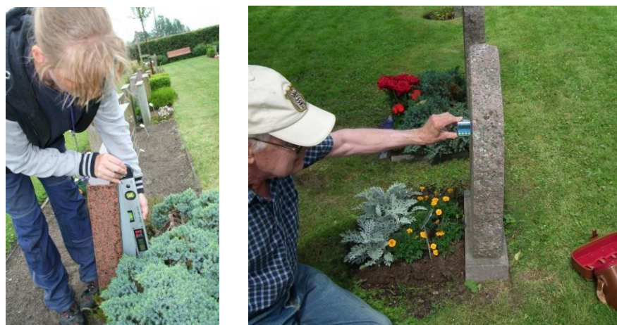
Figur 12. Kontroll av lutning med vinkelindikatorer.
