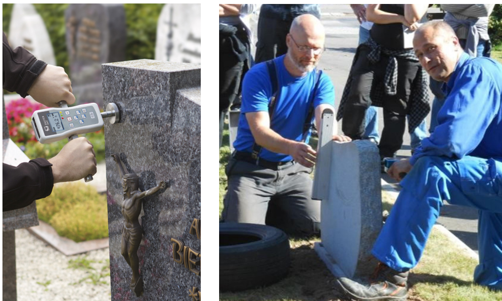
Figur 10. Mätning med tryck-/draginstrumentet. Här med tryck mot en hög respektive en låg gravvård.
