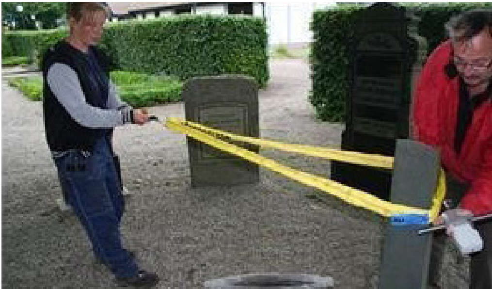
Figur 6. Belastningstest med fjädervåg, lyftstroppslinga och fender, här i form av bildäck.
