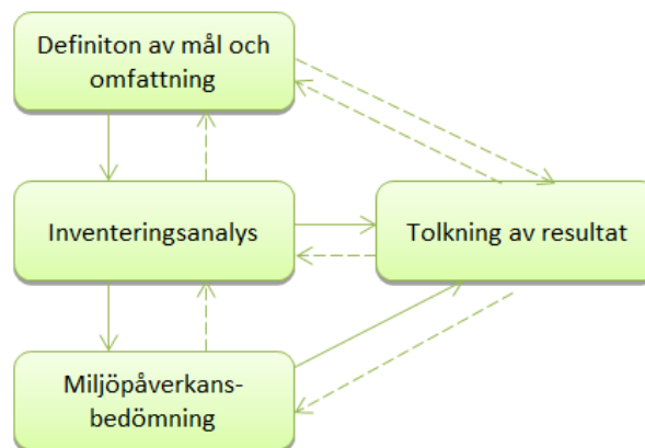
Figur 1: Översikt av LCA-proceduren. Pilarna indikerar i vilken ordning de olika stegen utförs. Streckade pilar indikerar möjliga iterationer. (Anpassad från Baumann and Tillman, 2004).
