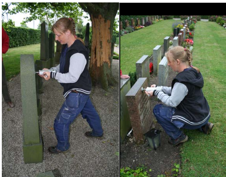
Figur 12. Mätning med tryck-/draginstrumentet. Här med tryck mot en hög resp en låg sten.
