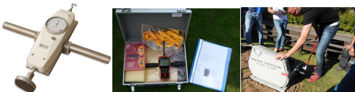
Figur 11. Tre gravstensinstrument. Till vänster FA-500 G från Elastocon AB, Brämhult, i mitten Sauturs instrument komplett i väska och med handledning på svenska, från SweTest, Saltsjö-Boo, Båda med tydlig display, tryckplatta och dragkrok och till höger det av Orax speciellt framtagna instrumentet för prövning av gravstenssäkerhet. Priset är ca SEK 4 000:- + moms (2013).
