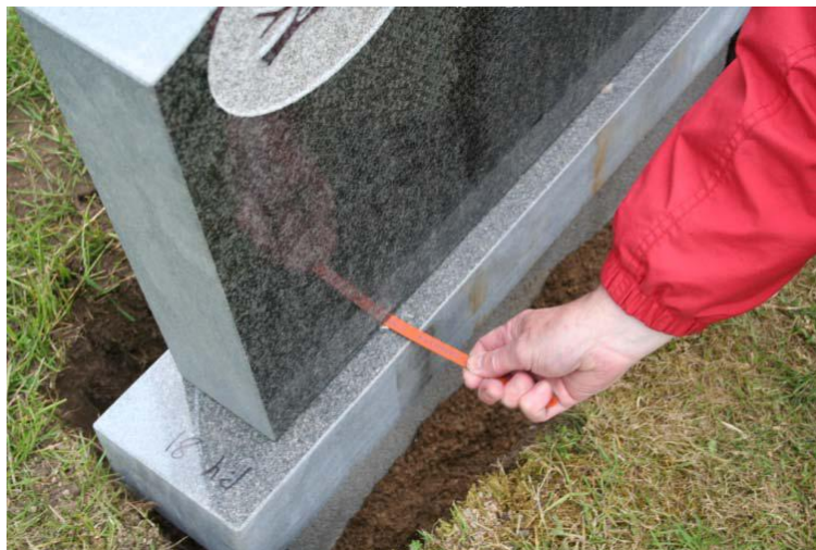
Figur 8. Kontroll av antalet dubbar med bågfilmsblad
